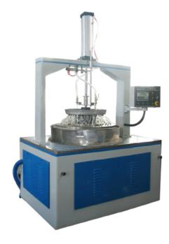
项目组研制出的采用本项新技术的研磨机,即新型高速研磨机。由于性能先进,有关的研磨机样机已在国研磨机内十几家单位得到了应用,而且还两次出口到澳大利亚,受到了国内外用户的普遍好评。本项技术于用于个别件的加工中,应用得还不够普遍,还应进一步完善加工工艺,优化研磨工艺参数,扩大研磨加工范围;还要完善研磨机,提高研磨机性能,改进研磨机造型,使其达到实用化、商品化的程度,以便更地推广应用。研磨机的主要类型有圆盘式研磨机、转轴式研磨机和各种专属研磨机。研磨机圆盘式研磨机分单盘和双盘两种,以双盘研磨机应用为普通。研磨机在双盘研磨机(见图[双盘研磨机])上,多个工件同时放入位于上、下研磨盘之间的保持架内,保持架和工件由偏心或行星机构带动作平面平行运动。下研磨盘旋转,与之平行的上研磨盘可以不转,或与下研磨盘反向旋转,并可上下移动以压紧工件(压力可调)。此外,上研磨盘还可随摇臂绕立柱转动一角度,以便装卸工件。双盘研磨机主要用于加工两平行面、一个平面(需增加压紧工件的附件)、外圆柱面和球面(采用带V形槽的研磨盘)等。加工外圆柱面时,因工件既要滑动又要滚动,须合理选择保持架孔槽型式和排列角度。
