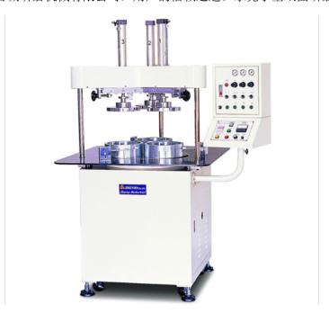
陶瓷平面研磨机在进行研磨抛光过程中冷却研磨盘的重要性:从事平面研磨的朋友都知道在超精密研磨抛光较薄脆零件过程中,研磨盘和工件是做相对摩擦运动的,研磨盘与工件的局部接触区域往往会出现高温,有时甚至可以达到几百度。局部的高温不但会烧伤零件表面,形成加工变质层,而且会引起零件的局部变形,同时,局部高温区的热量还会以热传导的方式传到整个研磨盘,使研磨盘也会发生热变形,研磨盘作为研磨加工的磨具,其面型精度能在一定程度上"复制"到工件表面。因此,陶瓷平面研磨机在进行研磨抛光过程中研磨盘自身的热变形对工件的面型精度一定会有影响。而且研磨盘温度越高,越不均匀,工件所受的变形影响越大。因此及时地将局部研磨盘高温区的热量驱散,合研磨盘各部分的温度比较均匀且处于较低的水平是非常的必要的。深圳炜安达所研发的研磨盘冷却系统可以均匀快速的达到冷却效果,保证了研磨工艺的要求。东莞小型双面研磨机研磨机设备,就选温州市百诚研磨机械有限公司,让您满意,欢迎您的来电哦!
